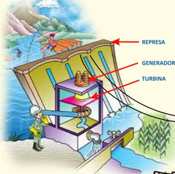
La planta hidroeléctrica utiliza agua almacenada para generar electricidad. Las represas pueden ser construidas para retener agua proveniente de una caudal natural. Esta agua fluye a través de una tubería llamada tubo de presión y empuja los alabes de una turbina, haciéndolos girar. La turbina mueve el generador para producir electricidad.
